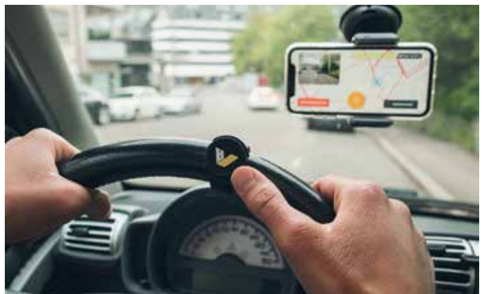
An der Windschutzscheibe befestigt, macht das Smartphone alle vier Meter ein Bild von der Straße und liefert damit eine objektive Zustandserfassung.
